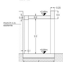
**Sezione solai di copertura**
